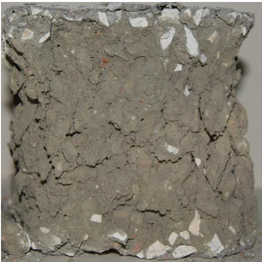
Фигура 2. Макроструктура на бетонни проби, разрушени при различна температура: а), в) и д) бетон без рециклирани доб. материали; б), г) и е) бетон с рециклирани добавъчни материали.
