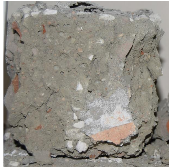
Фигура 2. Макроструктура на бетонни проби, разрушени при различна температура: а), в) и д) бетон без рециклирани доб. материали; б), г) и е) бетон с рециклирани добавъчни материали.
