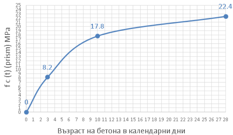
Фиг.3 Призмна якост на натиск на бетона
