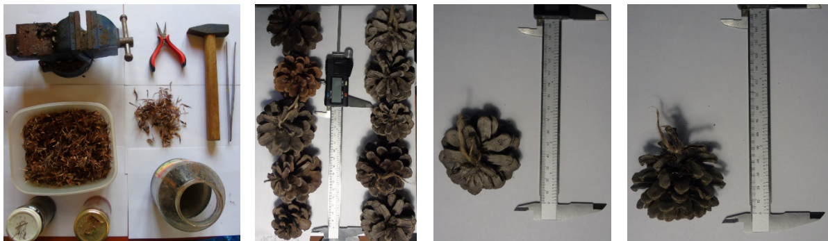
Фиг. 4. Предварително проучване на възможността за извличане на целулозни влакна от шишарки.
