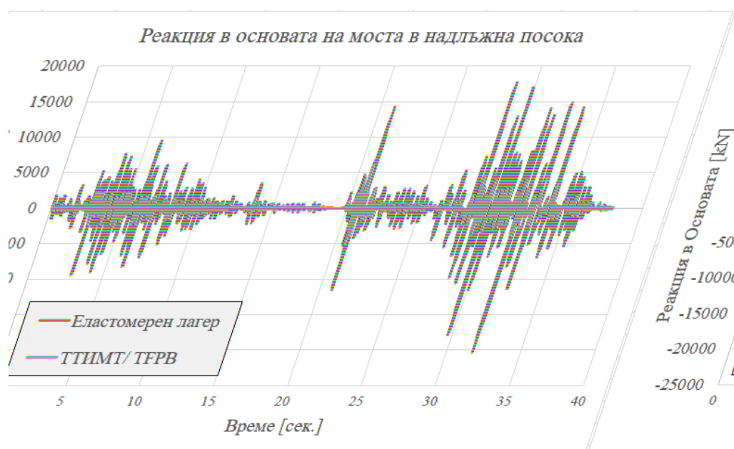
Фигура 5. Реакция в основата на моста в надлъжна посока
