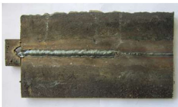
Фигура 13. Заваръчен шев изпълнен с базични електроди за изпитване на ударна жилавост
