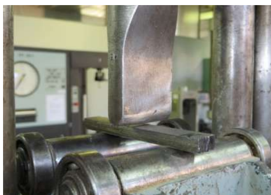
Фигура 11. Изпитване на огъване за заваръчен шев по BS EN 910 -1996 [22]
