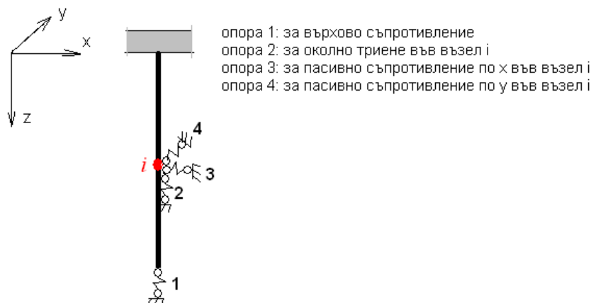
Фигура 4. Типове дискретни пружинни опори за пилот
