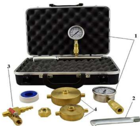
Фигура 2. Необходимо оборудване за проверка на дебита на пожарни хидранти съгласно NFPA 291
