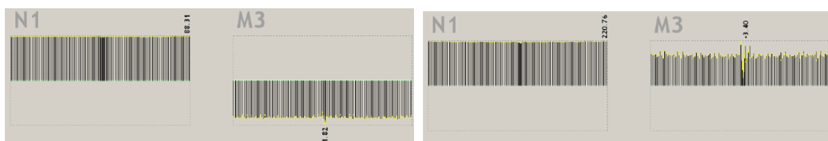
Фигура 8. Диаграма на максималните стойности на разрезните усилия N и M от Модел 4, на опорния пръстен, при: а) пълен и незасипан резервоар; б) празен и засипан резервоар
